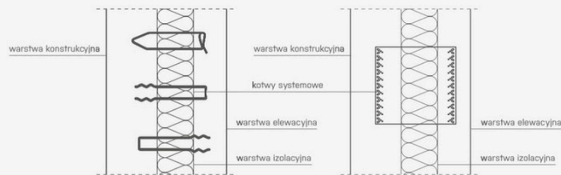
Prawidłowe położenie izolacji w połączeniu ściany warstwowej ze słupem
